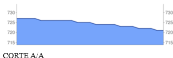
Figura 5 – Desnível do lote
